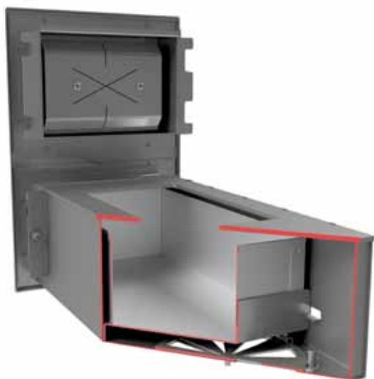
CPV - CENTRÁLNÍ PŘISÁVÁNÍ VZDUCHU DO POPELNÍKOVÉ KOMORY
